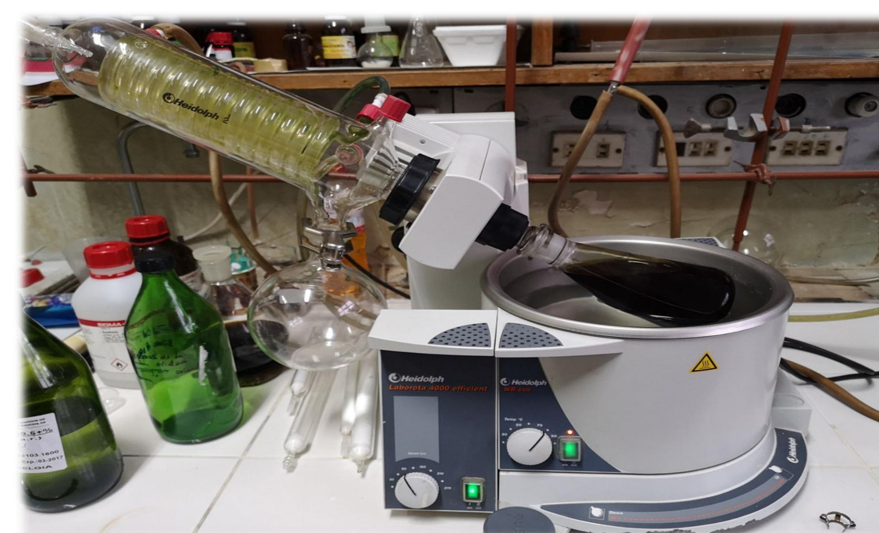
Fig.1 . Etapele de distilare și fracționare a extractelor hidroalcoolice de levănțică
